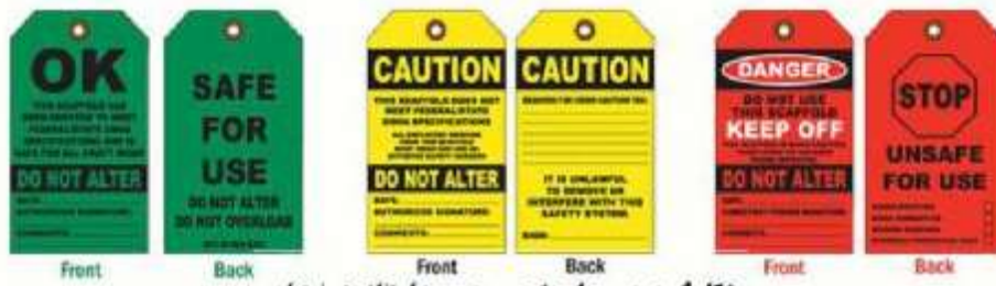
شکل ۹- برجسب های بست و روی مورد استفاده در لردیان
