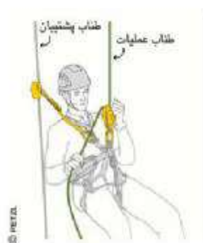
شکل ۸۵- تکیاره شوک گیر با ابزار Y MGO
