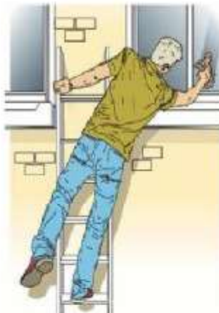
شکل ۱۱- استقرار غلط برای کار
