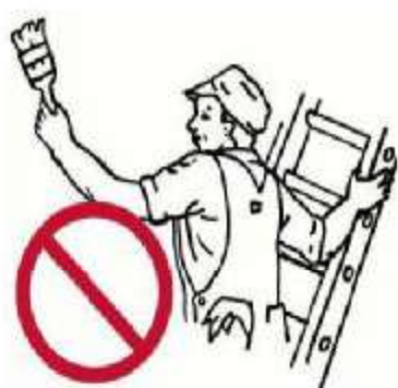
شکل ۱۶- نحوه استقرار غلط بر روی نردبان
