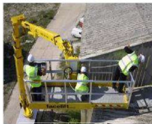
شکل ۱۱۸- بالابر سیار هیدرولیکی پشت کامیونی
