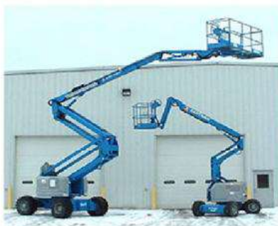
شکل ۱۱۷- بالابر سیار هیدرولیکی
