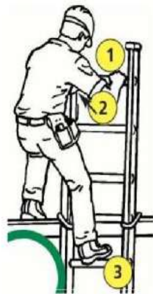
شکل ۱۵- نحوه استقرار بر روی لردیان بصورت صحیح برای کار
